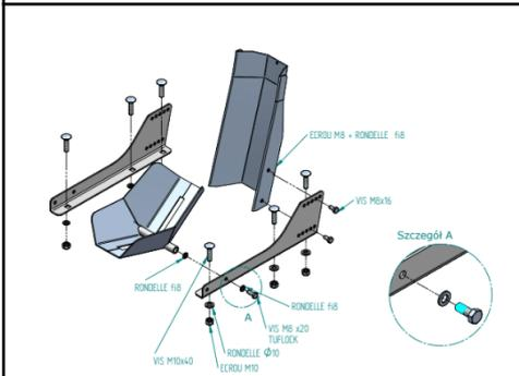
Bloque roue pour moto permet de tenir la moto droite pour la sangler sans avoir besoin de la mettre sur la béquille. Réf :K150.414
