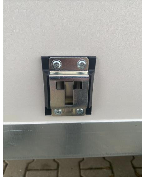
Arrêts de portes, partie sur la carrosserie pour éviter les battements au vent lors d'un chargement.
