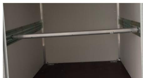
Barre d'arrêt de chargement. Permet de bloquer le chargement, de le fixer afin qu'il n'influe pas sur comportement routier de la remorque. Spécialement conçue pour exercer l'effort approprié à la carrosserie de la remorque Réf :K072154
