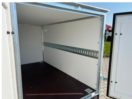
Rails pour barre d'arrêt du chargement montés dans l'équipement de série.
