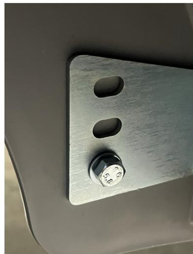
Garde boues montés indépendamment de la carrosserie avec des supports réglables en hauteur à 6 positions
