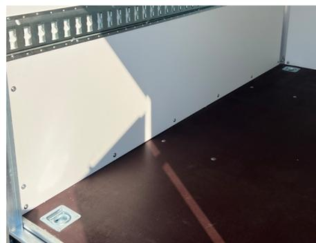
4 Crochets de sanglage intégrés dans le plancher et fixés au châssis.
