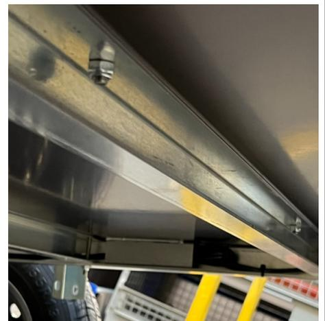
Ni rivet, ni vis autoperforante! Plancher fixé avec des vis inox et des écrous frein pour permettre une meilleure solidarité entre ce dernier et le châssis.
