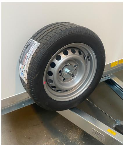
Support de roue de secours sur parois avant. Nécessaire avec l'option support central de roue jockey (K10.213) Ref : K81901
